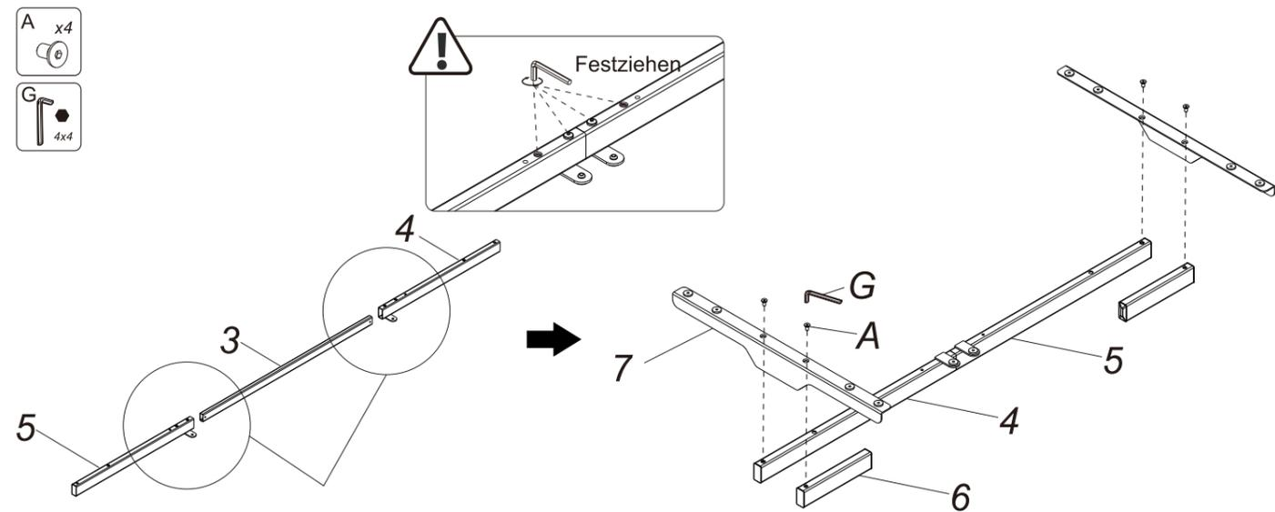
Verbinden Sie linken und rechten Tragbalken (4, 5) mit der Verbindungsstange (3) und ziehen Sie sie mit dem Inbusschlüssel (G) fest.
