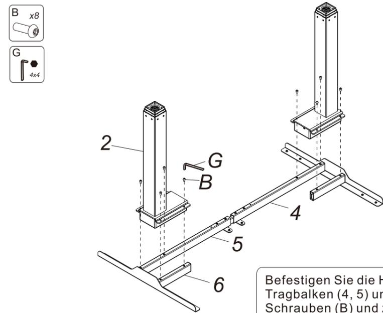
Befestigen Sie die Hubsäulen (2) an den Tragbalken (4, 5) und den kurzen Balken (6) mit Schrauben (B) und ziehen Sie sie mit dem Inbusschlüssel (G) fest.
